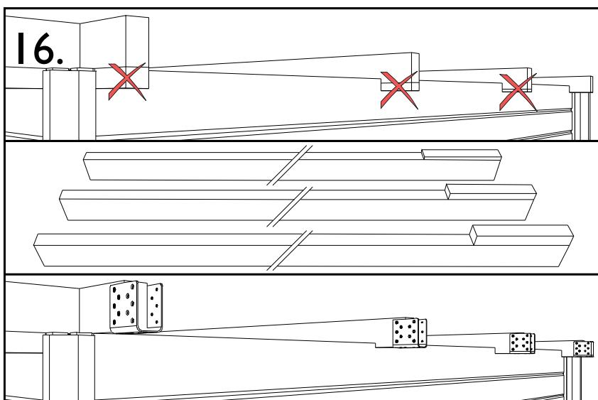
**NL:** Verwijder de eerder gemonteerde latjes S44 van de dakbalken van de tuinberging (zie punt 7) langs de kant van de extensie en monteer deze op de zelfde manier op 3 balken van de extensie. Monteer op elke balk van de tuinberging langs de kant van de extensie de balkverlengers met vijzen van 35mm.
