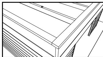
**NL:** Nagel nu de stormsierlatten SSL op de frontale sierlatten FSLM. Begin met de voorste, voor de modellen met extensie bestaat deze uit 2 stukken, en daarna deze aan de zijkant. Deze latten moeten nog op lengte gezaagd worden.
