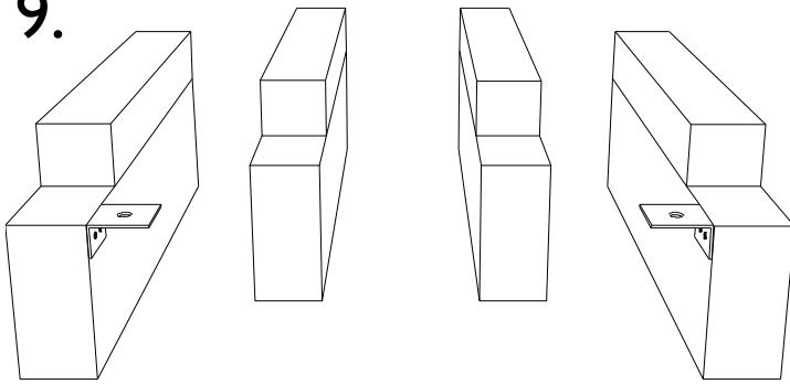
**NL:** Vijs de overgebleven latjes S44 op de uiteinden van de hulpdakbalken P1 (HDBM) uit het basis pakket (4 of 5 stuks). Bevestig op 2 van de 4 hulpdakbalken, gelijk met de boven zijde zoals op de tekening, een hoekijzer van de stormbeveiliging, 1 maal links en 1 maal rechts. Gebruik hiervoor telkens 2 vijzen van 35 mm.
