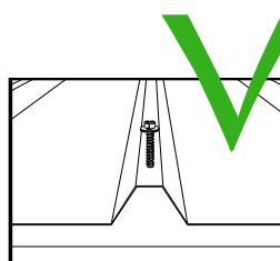
**NL:** Plaats de frontale sierlatten FSLM op de zijkanten. Vijs telkens vast in de dakbalken met 2 vijzen van 50 mm. Plaats nu de frontale sierlijst FSLM vooraan, bij de modellen met extensie bestaat deze lat uit 2 stukken. Vijs telkens vast op de hulpdakbalken. Achteraan is er geen gelijkaardige sierlat voorzien omwille van eventuele problemen die zich zouden kunnen voordoen met vocht. Vijs ook vast op de sierlaten van de zijkant met 3 vijzen van 35 mm.
