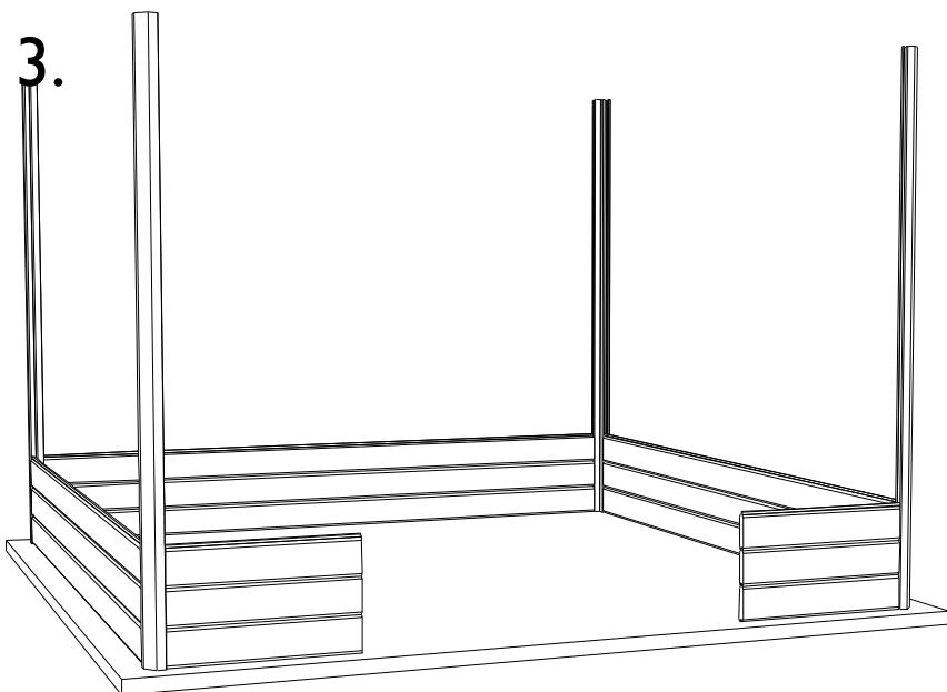
**NL:** Bouw verder op zoals aangegeven op de detailtekening tot u een 3-tal planken hoog bent. Om de haaksheid te garanderen dient u telkens laag per laag op te bouwen. U loopt tijdens de opbouw dus telkens rond de tuinberging en laat 1 plank zakken in de profielen, dan begeeft u zich naar de volgende wand enz.
