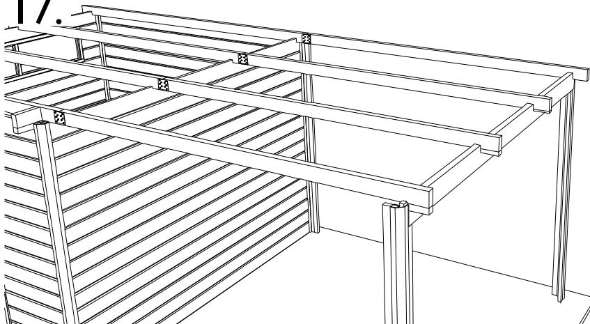
**NL:** Plaats alle dakbalken van de extensie. Aan de ene kant in de balkverlengers en aan de andere kant in de uitsparingen van de langsligger P2R (voor de modellen met meer dan 4 balken haalt u de blokjes met een beitel uit de overgebleven inkepingen). Herpositioneer evenueel de zijkant zodanig dat de langsligger P2R tegen de gemonteerde latjes S44 op de dakbalken komt. Zet vast met de bijgeleverde hoekijzers.
