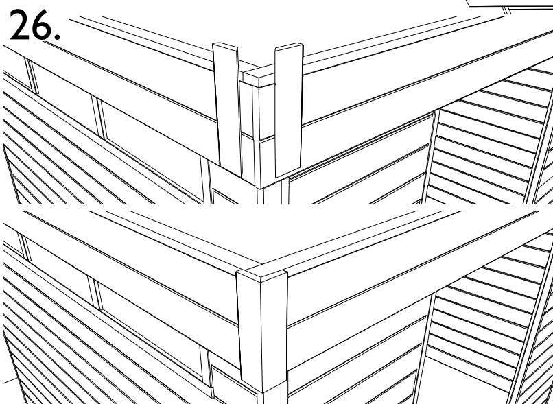
**NL:** Op de 2 voorste hoeken komen tot slot nog de L-profielen om de aansluiting van de frontale sierlatten te maskeren. Deze L profielen vormt u door 2 hoeksierlatten op versteek tegen elkaar te zetten en te vijzen met vijssjes van 25 mm. Voor de modellen met extensie komt er nog een latje SSL daar waar de 2 voorste FSLM samen komen
